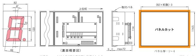
※設定ユニットは上位2桁の表示器に装着されます。
