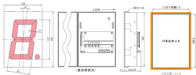
※設定ユニットは上位1桁の表示器に装着されます。
