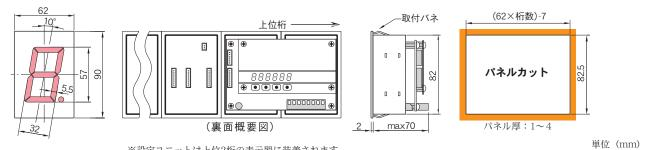
※設定ユニットは上位2桁の表示器に装着されます。
